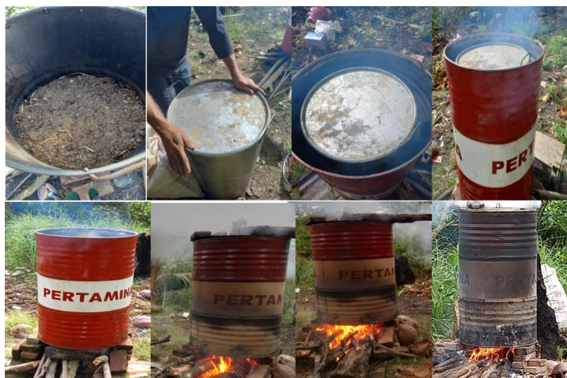
Gambar 6.. Proses pembakaran feses sapi menjadi biochar menggunakan kiln drum sederhana
